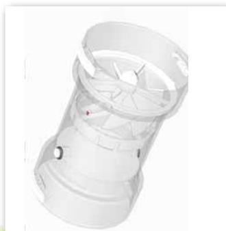
Metrovent è conforme alla normativa EN 12599 per il bilanciamento degli impianti di ventilazione.
