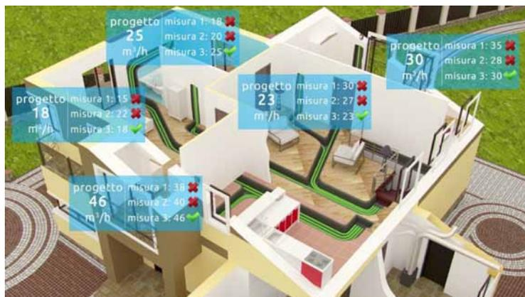
Diffusi rilevamenti statistici evidenziano che e' necessario ripetere in media tre volte le iterazioni sopra descritte (in particolare eseguire le misurazioni di tutte le bocchette, con le relative correzioni sui circuiti) prima di ottenere un risultato soddisfacente, con un notevole dispendio di tempo.
