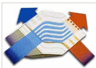
Per ottenere l'elevata efficienza di recupero delle moderne unità di ventilazione, spesso superiore al 92%, è necessario che i flussi aria di immissione e di espulsione siano di uguale portata.
