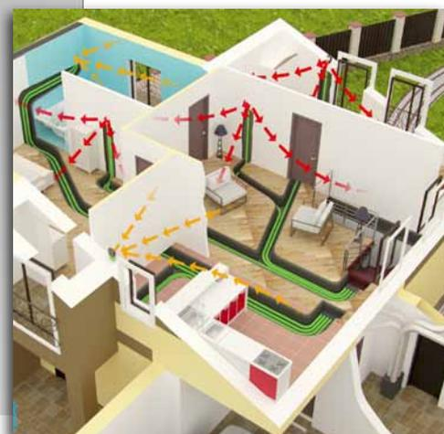
METROVENT è la soluzione Ideal Clima per un bilanciamento rapido, preciso ed affidabile delle reti aria di ventilazione. È specificatamente progettato per applicazioni di ventilazione meccanica controllata a recupero energetico.
